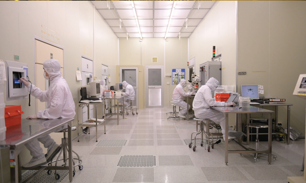
ห้องคลีนรูม class 100 สำหรับ small-volume production line บนเวเฟอร์ 6 นิ้ว ของทีเมค
