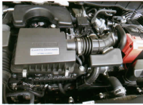
■ เครื่องยนต์บล็อก P10 A6 แบบ DOHC 3 สูบ 12 วาล์ว VTEC Turbo 988 ซีซี. 122 ps ที่ 5,500 รอบ/นาที และแรงบิดสูงสุด 17.6 กก.-เมตร ที่ 2,000-4,500 รอบ/นาที
