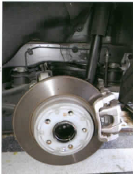
■ เบรคหลังใช้ดิสค์แบบไม่มีช่องระบายความร้อน
