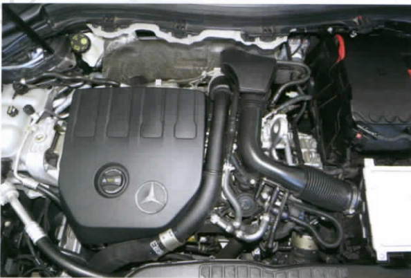
■ เครื่องเบนซินสี่สูบ M 282 แบบ DOHC แถวเรียง 4 สูบ 16V เกอร์โบตัวเดียว ความจุ 1,332 ซีซี. มีแรงม้า 120 kW หรือ 163 แรงม้าที่ 5,500 รอบ/นาที พร้อมแรงบิดสูงสุด 250 Nm หรือ 25.5 กก.-เมตรที่ 1,620-4,000 รอบ/นาที
