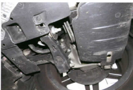
■ ด้านหลังเป็นมิวติลิงค์มีแผ่นพลาสติกปิดป้องกัน
