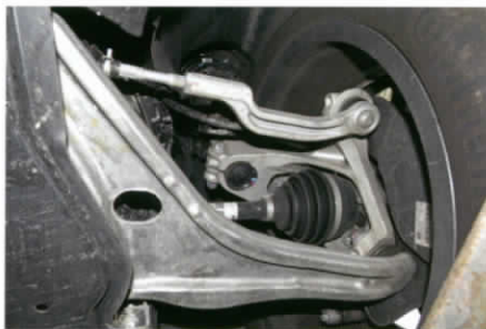
■ ระบบกันสะเทือนด้านหน้าเป็นแม็คเฟอร์รอนสตรีก ปักนกกับหน้าแปลนล้อเป็นอะลูมิเนียม
