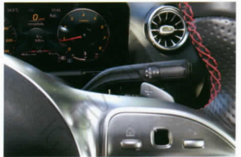
■ คันเกียร์แบบอิเล็กทรอนิกส์อยู่ด้านบนทางขวาของคอกพวงมาลัย
