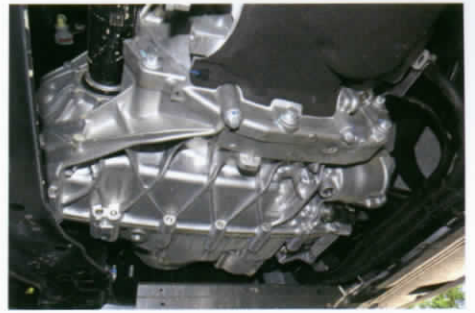
■ ชุดเกียร์ 7 G-DCT แบบ 7 เกียร์ มีขนาดไม่โตนัก
