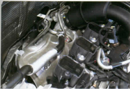
■ เมื่อเปิดฝาครอบเครื่องออก ก็จะได้เห็นคอยล์จุดระเบิด, แบตเตอรี่คอยล์เรียงรายอยู่ด้านบน ส่วนด้านหลังเครื่องเป็นที่อยู่ของชุดเกียร์
