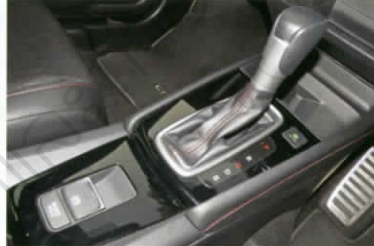
■ กุญหนังกุ่มเกียร์เดินด้วยแคงสโตสสปอร์ต ด้านบนคอมโซลเกียร์ทางด้านขวาซ้ายเป็นสวิตช์ ECON สำหรับการขับเคลื่อนประหยัด ด้านล่างเป็นเบรกมือไฟฟ้า กับ Brake Hold
