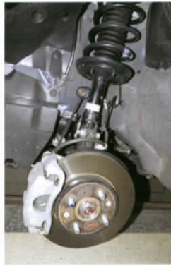
■ ด้านหน้าเป็นดิสก์เบรกแบบมีช่องระบายความร้อน
