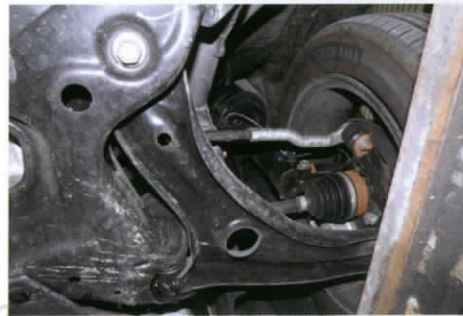
■ ช่วงล่างหน้าเป็นแบบแม็คเฟอร์สันสตรัท
