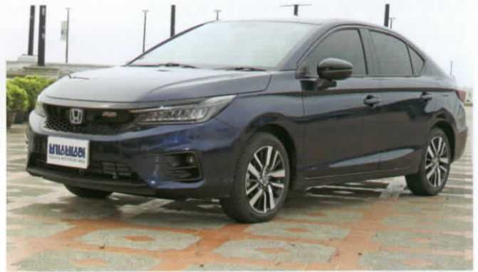
■ ไฟหน้าและไฟส่องกลางวันเป็น LED รวมทั้งไฟตัดหมอก กระงังหน้าสีดำ Gloss Black พร้อมสัญลักษณ์ RS
