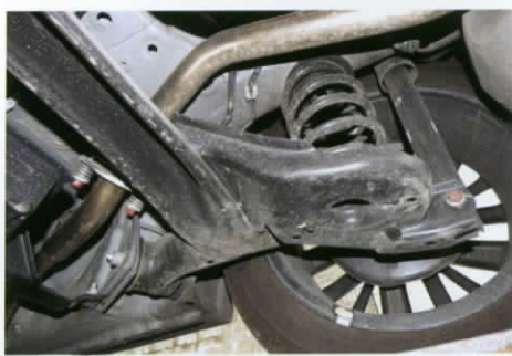
■ ด้านหลังใช้ระบบช่วงล่างแบบทอร์ชั่นบาร์
