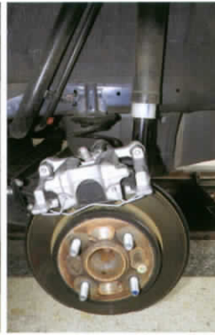
■ ด้านหลังเป็นดิสก์เบรกแบบไม่มีช่องระบายความร้อน
