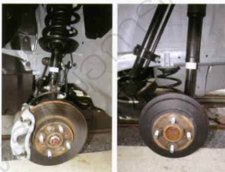
(ซ้าย) ด้านหน้าใช้ดิสค์เบรคแบบมีช่องระบายความร้อน (ขวา) ด้านหลังเป็นดรัมเบรค
