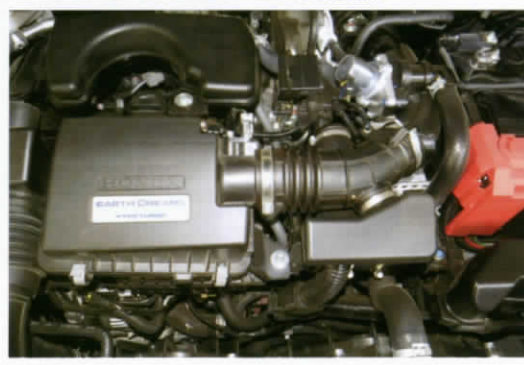
■ เครื่องยนต์บล็อก P10 A6 แบบ DOHC 3 สูบ 12 วาล์ว VTEC Turbo 988 ซีซี. มีพลัง 90 kW หรือ 122 ps ที่ 5,500 รอบ/นาที และมีแรงบิดสูงสุด 173 Nm หรือ 17.6 กก.-เมตร ที่ 2,000-4,500 รอบ/นาที
