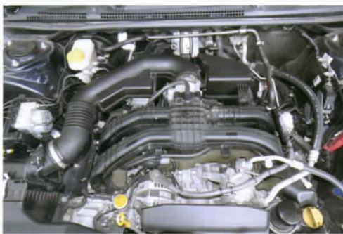
■ เครื่องยนต์บล็อก FB 20 แบบ DOHC 4 สูบนอน 16 วาล์ว ความจุ 1,995 ซีซี. มีแรงม้า 156 แรงม้า ที่ 6,000 รอบ/นาที และมีแรงบิดสูงสุด 20 กก.-เมตร ที่ 4,000 รอบ/นาที
