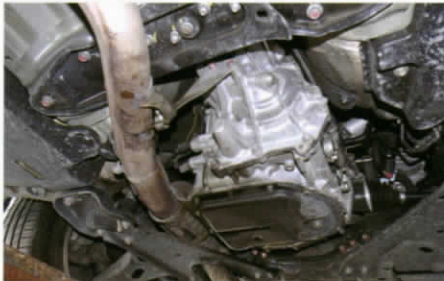
■ เกียร์ CVT GEN II TR 580 มีขนาดสั้นกว่า GEN I TR 690 อยู่ 100 มม. และเบาขึ้น 15 %
