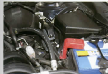
■ กล่องควบคุมของ DENSO ติดตั้งอยู่ในห้องเครื่องด้านซ้าย
