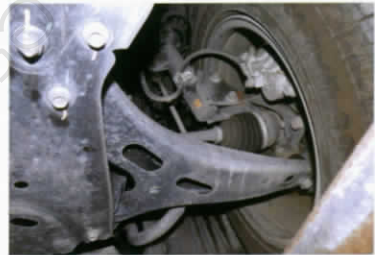
■ ช่วงล่างด้านหน้าเป็นแบบแม็คเฟอร์สันสตรัท
