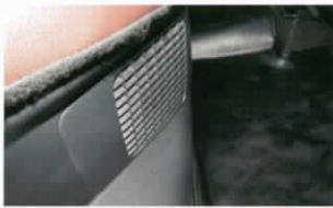
■ ช่องอากาศเข้าของแบตเตอรี่ Hybrid สำหรับระบายความร้อน อยู่ที่เบาะนั่งด้านขวา
