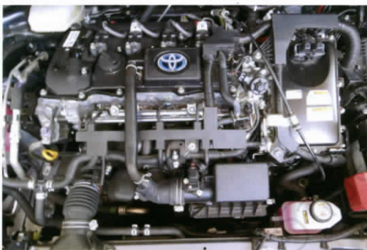
■ เครื่อง 2 ZR-FXE แบบ DOHC 4 สูบ 16 วาล์ว ระบบ VVT-i ความจุ 1,798 ซีซี. 98 แรงม้า ที่ 5,200 รอบ/นาที และมีแรงบิดสูงสุด 14.5 กก.-เมตร ที่ 3,600 รอบ/นาที พร้อมมอเตอร์ 53 kW
