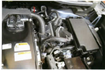
■ กล่องควบคุม PCU (Power Control Unit) ติดตั้งเอาไว้ในห้องเครื่องด้านซ้ายหลังแบตเตอรี่
