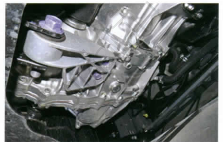
■ เกียร์ E-CVT พร้อม Shift Lock มีขนาดกะทัดรัด
