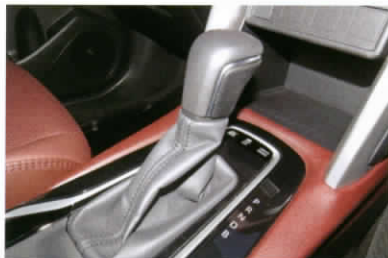
■ กับเกียร์สลับพร้อมปุ่มบังคับบนของคอนโซลเกียร์ เป็นสวิตช์ EV MODE สวิตช์ระบบ TRC และ VSC กับสวิตช์ DRIVE MODE
