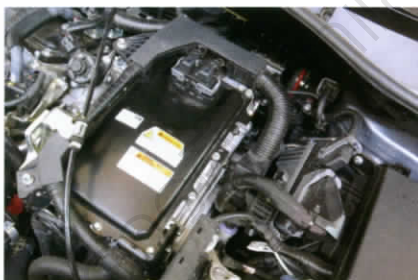
■ ชุด Inverter ของมอเตอร์ไฟฟ้า
