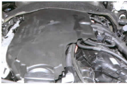
■ ใต้ฝาครอบเครื่องจะเป็นแผ่นยางกันเสียง
