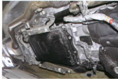
■ เกียร์อัตโนมัติแบบ 8 จังหวะแบบ Steptronic ของ ZF
