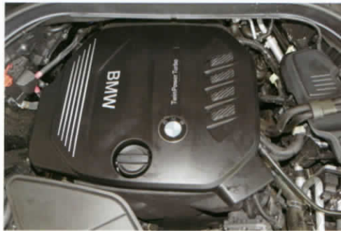
■ เครื่องยนต์ดีเซลบล็อก N 47 D 20 แบบ DOHC 4 สูบ 16 วาล์ว 1,995 ซีซี. มีแรงม้า 190 แรงม้าหรือ 140 kW ที่ 4,000 รอบ/นาที และแรงบิดสูงสุด 40.8 กก.-เมตร หรือ 400 Nm ที่ 1,750-2,500 รอบ/นาที
