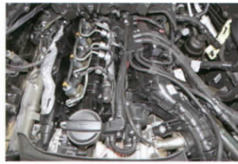
■ เมื่อเปิดฝาถังออกก็จะเจอกับหัวฉีดของ BOSCH แบบพลา๊ก PIEZO
