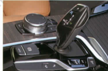
■ คันเกียร์มีฟังก์ชันปุ่มกดตำแหน่งเกียร์ไว้ที่หัวเกียร์ ด้านล่างเป็นสวิตช์เบรกมือไฟฟ้า พร้อมระบบ Automatic Brake Hold ส่วนทางด้านซ้ายเป็นปุ่ม iDrive สั่งงานได้ทั้งแบบปุ่มและแบบสัมผัสด้วย
