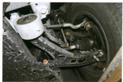
■ ช่วงล่าง ด้านหน้า เป็นสตรีก พร้อมเหล็ก กันโคลง
