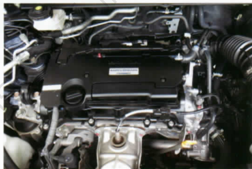
■ เครื่องยนต์เป็นบล็อก K 24 V5 แบบ DOHC 4 สูบ 16 วาล์ว i-VTEC ความจุ 2,356 ซีซี. พลัง 127 kW หรือ 173 ps ที่ 6,200 รอบ/นาที และมีแรงบิดสูงสุด 224 Nm หรือ 22.8 กก.-เมตร ที่ 4,000 รอบ/นาที
