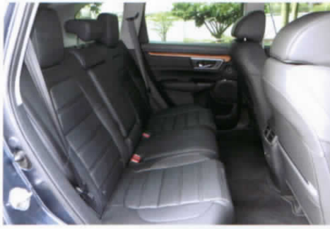
■ เบาะนั่งด้านหลังสามารถพับพนักพิงแบบซ้าย 60 ขวา 40
