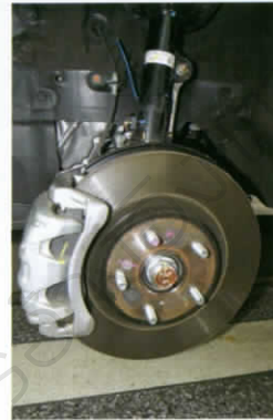
■ ด้านหน้าเป็นดีสค์เบรกแบบมีช่องระบายความร้อนหนา 28 มม. คาลิเปอร์คู่
