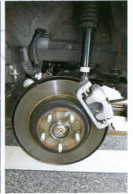
■ ด้านหลังเป็นดีสค์เบรกหนา 10 มม. ใช้คาลิเปอร์เดี่ยวของ NISSAN
