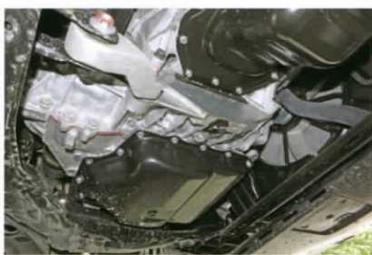
■ เกียร์อัตโนมัติ SKYACTIV-Drive แบบ 6 จังหวะ มีขนาดเล็กกะทัดรัด
