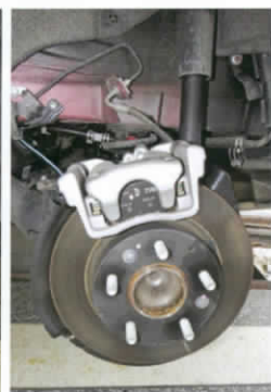
■ ด้านหลังเป็นดิสค์เบรคแบบธรรมดาไม่มีช่องระบายความร้อน
