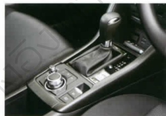
■ คันเกียร์แบบสปอร์ตพร้อมปุ่มคันเกียร์ 6 สวิตช์ขับเคลื่อนโหมดสปอร์ต สวิตช์เบรคมือไฟฟ้า พร้อมระบบ Auto Hold และปุ่มควบคุมอัจฉริยะ Center Commander
