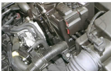
■ กล่อง ECU อยู่ข้างแบตเตอรี่ GS ขนาด 12 V 65 Ah
