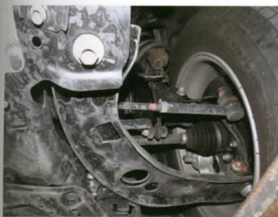
■ ระบบช่วงล่างหน้าแบบแม็กเฟอร์สันสตรัท
