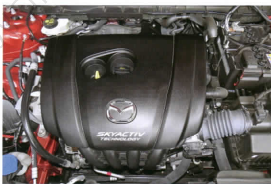
■ เครื่อง SKYACTIV-G รุ่น PE-VPS แบบ DOHC 4 สูบ 16 วาล์ว Dual S-VT 1,998 ซีซี. อัตราส่วนกำลังอัด 14 ต่อ 1 ปลดปล่อยออกมาได้ 115 kW หรือ 156 ps ที่ 6,000 รอบ/นาที พร้อมแรงบิดสูงสุด 204 Nm หรือ 20.8 กก.-เมตร ที่ 2,800 รอบ/นาที
