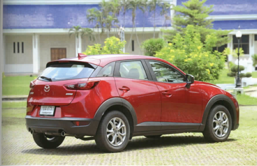
■ ไฟท้ายมีระบบสัญญาณไฟฉุกเฉินเตือนอัตโนมัติเมื่อเบรกกะทันหัน ESS (Emergency Signal System)
