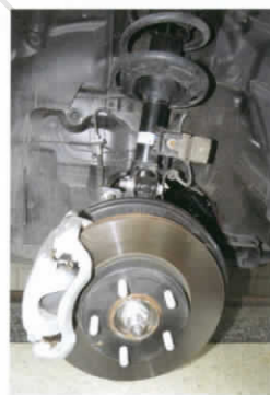
■ ด้านหน้าเป็นดิสค์เบรคแบบมีช่องระบายความร้อน
