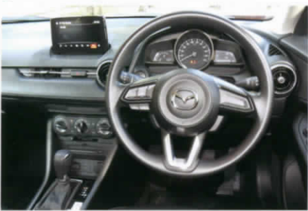
■ พวงมาลัยหุ้มหนังทรงสปอร์ตแบบสามก้านปรับสูง-ต่ำ โกล้-โกล่า พร้อมสวิตช์ควบคุมเครื่องเสียงและจอแสดงผลข้อมูลการขับขี่บนพวงมาลัย
