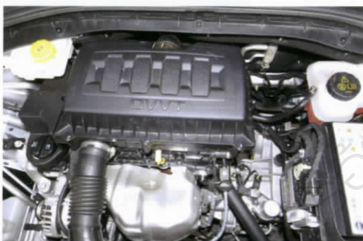
■ เครื่องยนต์ 1.5 S 4 C แบบ DOHC 4 สูบ 16 วาล์ว VTI-TECH ความจุ 1,498 ซี.ซี. 84 kW หรือ 114 ps ที่ 6,000 รอบ/นาที และมีแรงบิดสูงสุด 150 Nm หรือ 15.3 กก.-เมตร ที่ 4,500 รอบ/นาที
