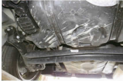
■ ด้านหลังใช้ระบบกันสะเทือนแบบทอร์ชันบีม
