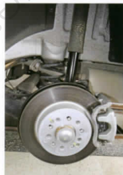
■ ด้านหลังเป็นดิสค์เบรค 8SSBC ไม่มีช่องระบายความร้อน
