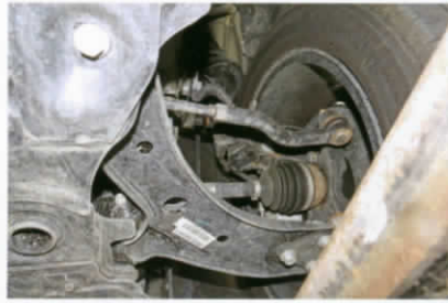
■ ระบบกันสะเทือนด้านหลังเป็นเบ้าเฟออสันสตรักพร้อมเหล็กกับคาน
