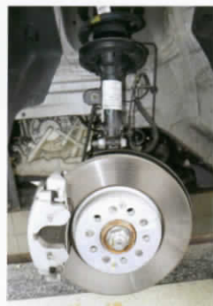
■ ด้านหน้าเป็นดิสค์เบรคแบบมีช่องระบายความร้อน
