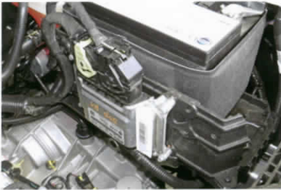
■ กล่อง ECU เป็น MOTRONIC ของ BOSCH Made in CHINA ติดตั้งอยู่ในห้องเครื่องฝั่งซ้ายข้างเบตเตอร์
