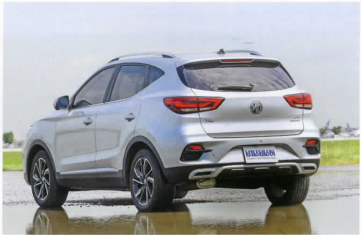
■ ไฟท้าย LED ทรงใหม่ พร้อมไฟเตือนการเบรคฉุกเฉิน ESS ไฟเบรคดวงที่ 3 แบบ LED สปอยเลอร์หลัง และที่ปิดฝากระโปรงท้ายสไลด์สปอร์ตไลท์ MG
