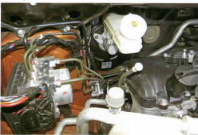
■ ตัวจ่ายน้ำมันเบรกเป็นของ BOSCH ทบ้อลมเบรกเป็นแบบชิ้นเดียว
