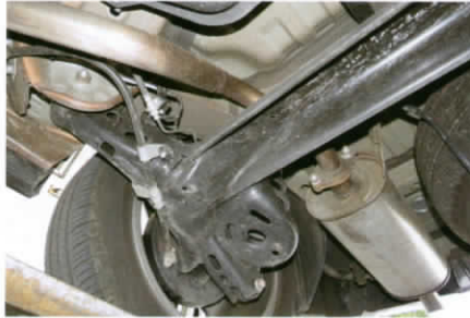
■ ด้านหลังใช้ช่วงล่างแบบ Torsion Beam
