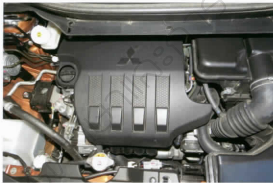
■ เครื่อง 4A91 แบบ DOHC MIVEC 4 สูบ 16 วาล์ว 1,499 ซีซี. มีพลัง 77 kW หรือ 105 ps ที่ 6,000 รอบ/นาที และมีแรงบิดสูงสุด 141 Nm หรือ 14.4 กก.-เมตร ที่ 4,000 รอบ/นาที
