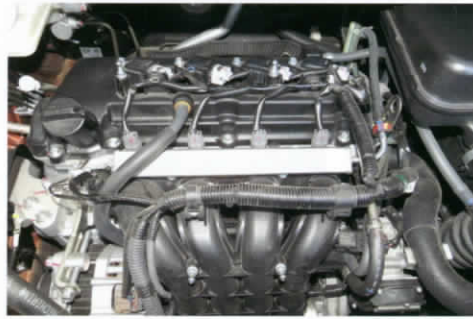
■ ระบบจุดระเบิดแบบ ไดเรกต์คอยล์สว่างบนฝา ครอบบวาล์ว พร้อมหัวฉีด อิเล็กทรอนิกส์ ECI-MULTI
