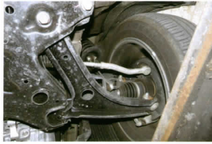
■ 11 ระบบช่วงล่าง ด้านหน้าเป็น McPherson Strut
