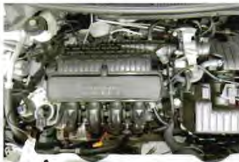
■ เครื่องยนต์บล็อก L 15 Z 1 แบบ SOHC 4 สูบ 16 วาล์ว i-VTEC ความจุ 1,497 ซีซี. บัพลัง 86 kW หรือ 117 ps
