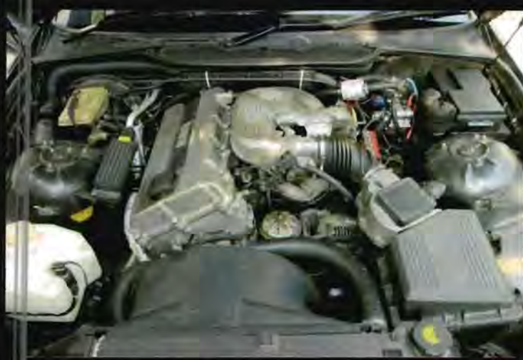
• M43 กับ M42 หน้าตาเหมือนแต่ต่างกันตรงทรงฝา/แรงบิด
