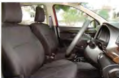
เบาะหน้าพับไฟฟ้าตัวเบาะปรับมือทั้งเลื่อนและเอน โดยทางดำนคนขับสามารถปรับระดับสูง-ต่ำได้ด้วย
