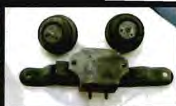
• หน้าตาของแท่นเครื่องเหมือนกันทุกจุด
